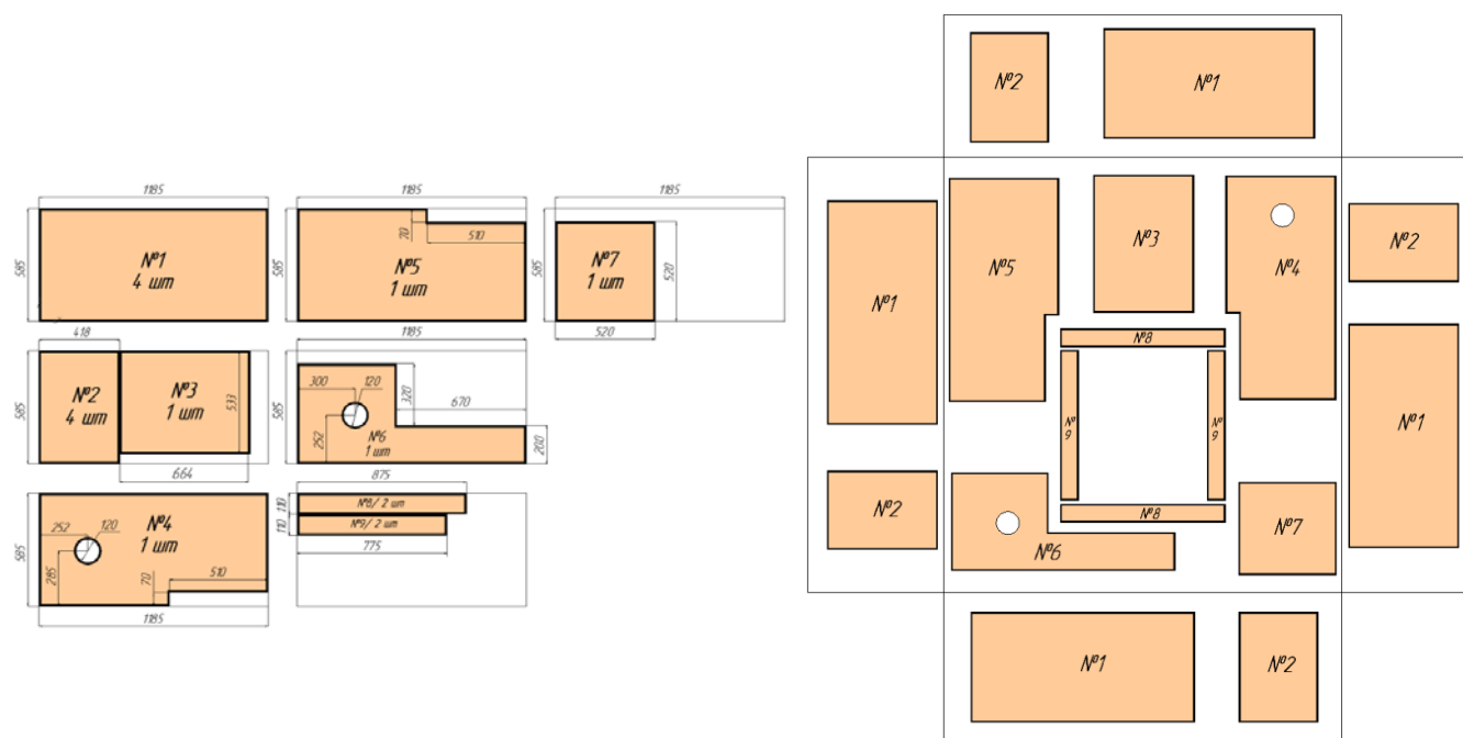
Рисунок 7 – Карта раскроя утеплителя
